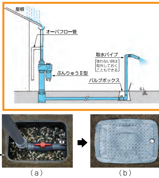
▲バルブボックス内のコックは「開」にしておくことによって、取水可能な状態になります（a）。また、長期間取水しない時は、取水パイプを取り外し、バルブボックスを閉じておくこともできます（b）。
