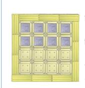
前頁のJICA事業ではコンクリート打設時の残置型枠としてレンガ積みによる方法を採用したが、その後、新たにUNフォームを開発・完成。
