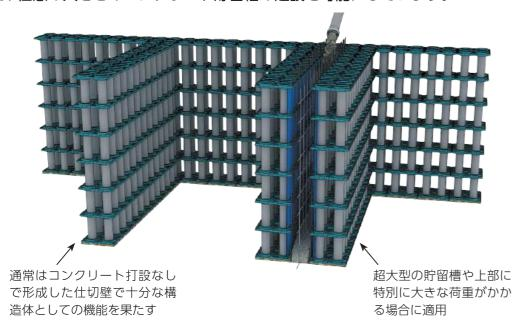
3 UNフォームは残置型枠としての機能を発揮するだけでなく、外周面を美観のある壁面に仕上げることが可能です。この機能によって、地下埋設型と同様の施工方法で、半地下型および地上設置型の建設が可能になりました。
