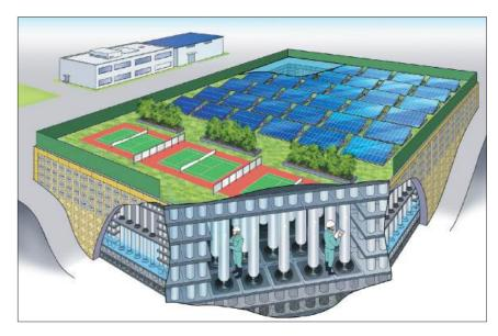
小規模半地上型 UN水貯留槽
