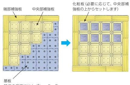
基板の背面にはセパレーターを セットする孔があって、上記仕切 板連結鉄筋と橋渡しした上で生 コンが投入されます。
