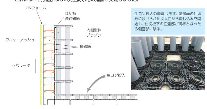
UN水貯留システムを構成するアクアパレス工法では、設置目的に応じて主SPパイプ(塩ビ管) の使用本数を増減することが可能です。
