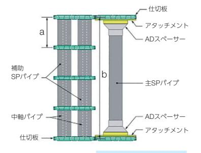
設置される仕切板の間隔 は、aが50cm、bは2m以下 を原則として構成します。
